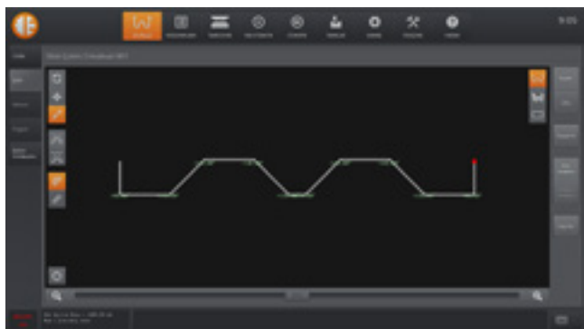
■ O desenho da peça 2D pode ser feito na tela do controlador
