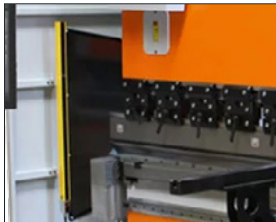
■ Cortina de luz de proteção corporal em conformidade com as normas CE, garantindo uma operação segura
