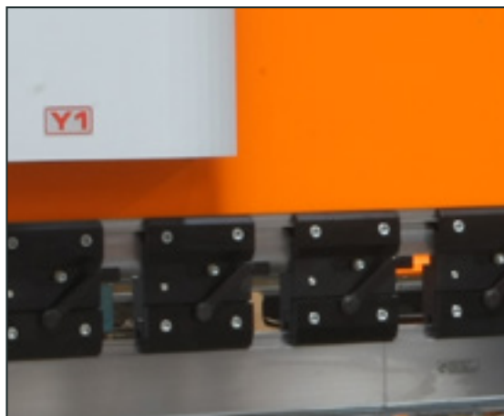
■ Sistema de fixação da ferramenta superior que pode ser instalado e removido manualmente com facilidade
