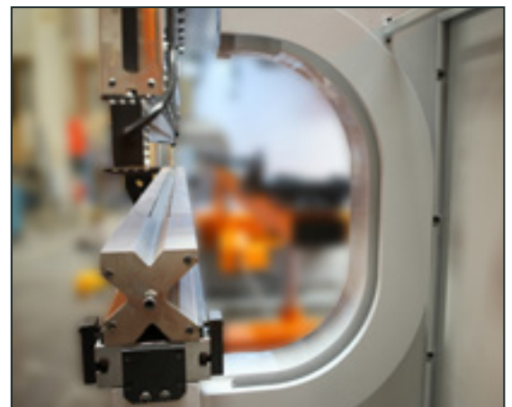
■ Para curvaturas largas (0) são oferecidos até 1500 mm de profundidade de garganta especial
