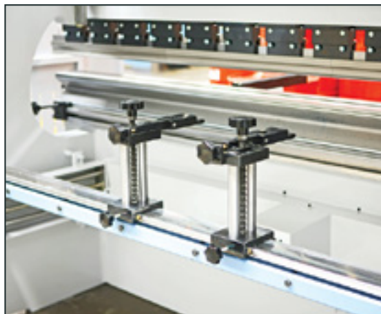
■ O sistema de batente padrão da Power-Bend Pro é oferecido como eixo X motorizado, eixo R manual movimento (S)
