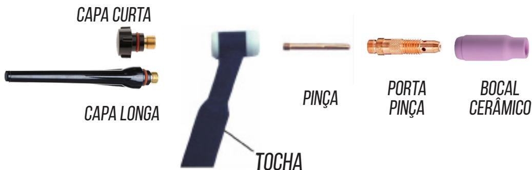
OBS: A capa da tocha fixa o eletrodo na pinça. Ao apertar a capa, ela empurra a pinça para a frente. Como o porta-pinça é cônico, a pinça se fecha em torno do eletrodo de tungstênio, fixando-o dessa forma.
