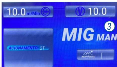
Com os respectivos potenciômetros realize os ajustes de TENSÃO, VELOCIDADE DO ARAME e de INDUTÂNCIA manualmente. (4)
