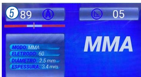
Com os respectivos potenciômetros realize os ajustes de CORRENTE (A) e de ARC FORCE (B) manualmente. (6)
