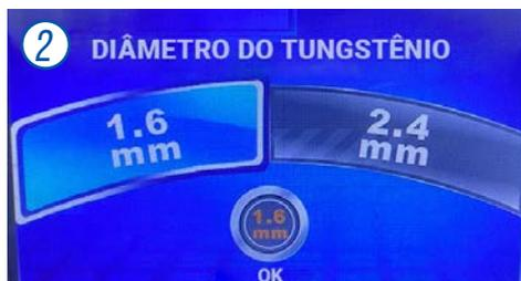
Embora o equipamento ofereça a escolha apenas dos diâmetros de eletrodos de 1,6 mm e 2,4 mm, outros diâmetros também podem ser utilizados, uma vez que o equipamento não limita a regulação da soldagem durante o processo.
