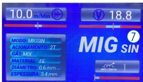
O modo SINÉRGICO faz os ajustes de TENSÃO, VELOCIDADE DO ARAME e de INDUTÂNCIA de forma automática a partir das informações preenchidas previamente no painel.
