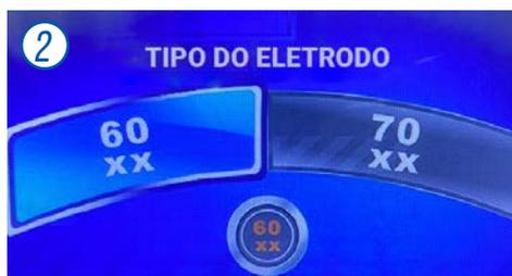
A designação **60XX** significa eletrodos rutilicos (por exemplo, E-6012, E-6013) e **70XX** significa eletrodos de base (por exemplo, E 7018).
