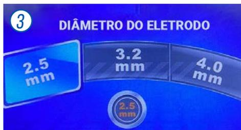
Embora o equipamento ofereça a escolha apenas dos diâmetros de eletrodos mais utilizados (de 2,5 mm a 4,0 mm), diâmetros menores, por exemplo, 1,6 mm e 2,0 mm, também podem ser utilizados, uma vez que o equipamento não limita a regulagem da soldagem durante o processo.
