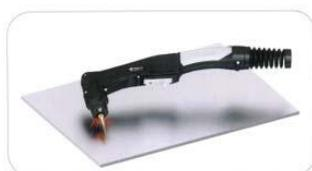
1. Segure a tocha angulada à peça, acione o gatilho para iniciar o arco e lentamente rotacione para a posição superior;
