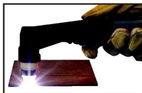
5. A amperagem e a velocidade de movimento certas são muito relevantes à espessura do material e ditam a quantidade de faíscas saindo do material. Se houver muitas faíscas saindo do material, uma das duas está errada.
