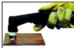
6. Para finalizar o corte, solte o gatilho. O fluxo de ar continuará por cerca de 15 segundos (apenas na função 4T) para esfriar a cabeça da tocha.
