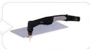
2. Aperte o gatilho para iniciar o arco principal. O arco de corte irá iniciar quando o bico da tocha estiver perto o suficiente da peça. Comece a cortar da borda até que o arco tenha cortado completamente a peça.
