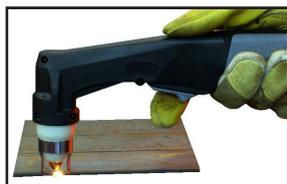
4. Aperte o gatilho para energizar o arco. O arco de corte vai iniciar quando o bocal for movido um pouco mais próximo da peça. Assim que o corte começar a acontecer, mova a tocha na direção que você deseja cortar.
